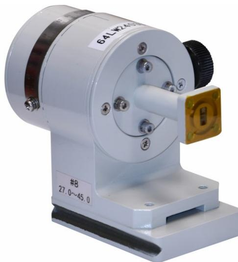
Рисунок 20 - ОУ 27,0-45,0 ГГц, 1 порт, линейная поляризация
